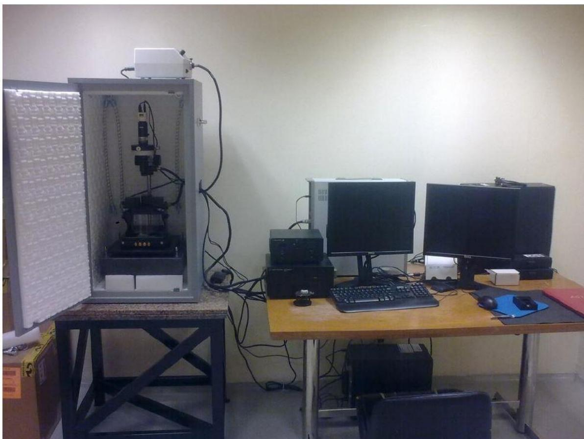
Figura 11: Microscopio Agilent 5500 SPM (AFM - STM). UNRC – Laboratorio nanotecnológico.
