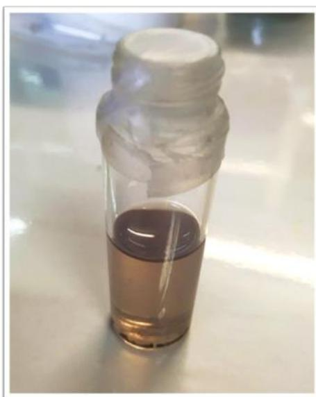
Figura 25: Imagen de la dispersión de  $\text{TiSe}_2$  luego del tratamiento solvotérmico en hidracina a  $180\text{ }^\circ\text{C}$  durante 3 horas. Se observa una dispersión conteniendo algunos fragmentos macroscópicos en la parte inferior del recipiente, los cuales son eliminados por centrifugación.
