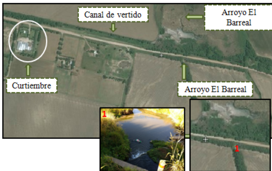
Figura 35: Imagen satelital y fotografías de la curtiembre Víctor Manuel Zabala S.A. y del arroyo el Barreal. En detalle se muestran los sitios de circulación o vertido de los efluentes provenientes de la curtiembre, la cual se ubica geográficamente a 32°34' de latitud Sur y 64°23' de longitud Oeste. Esta industria libera los efluentes de su manufactura en un canal sin revestimiento alguno, que se extiende colindante a un camino rural hasta alcanzar el cauce del arroyo El Barreal (1).
