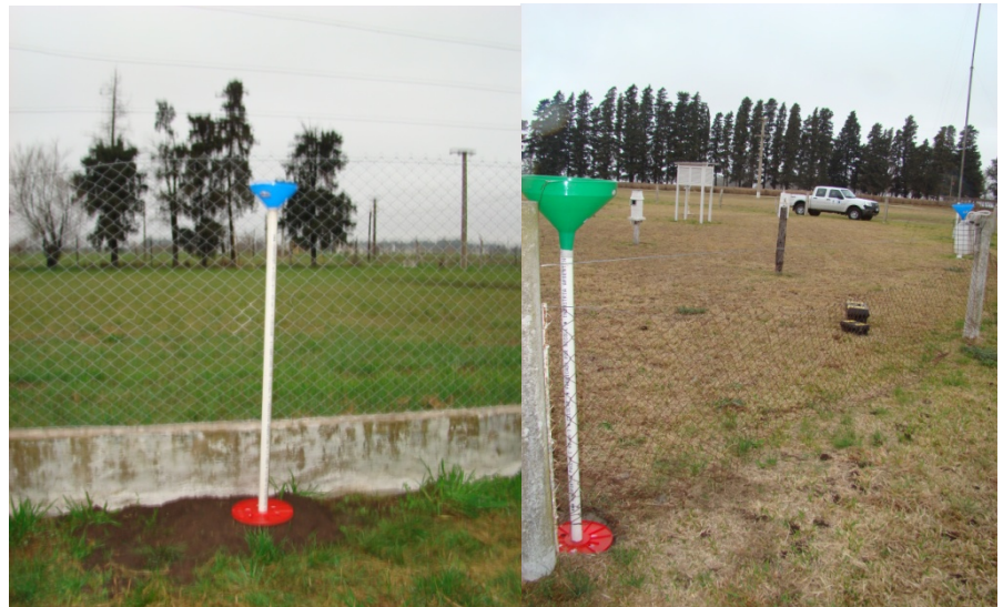
Figura 2.2. Colectores enterrados de agua de precipitación instalados. izq: UTN San Francisco, der: INTA Manfredi.
