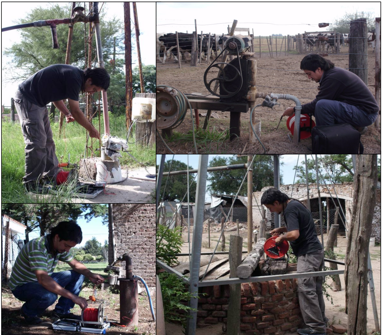
Figura 8.15 Mediciones de niveles estáticos y toma de muestra en pozos y perforaciones que explotan el acuífero libre en el área de estudio.
