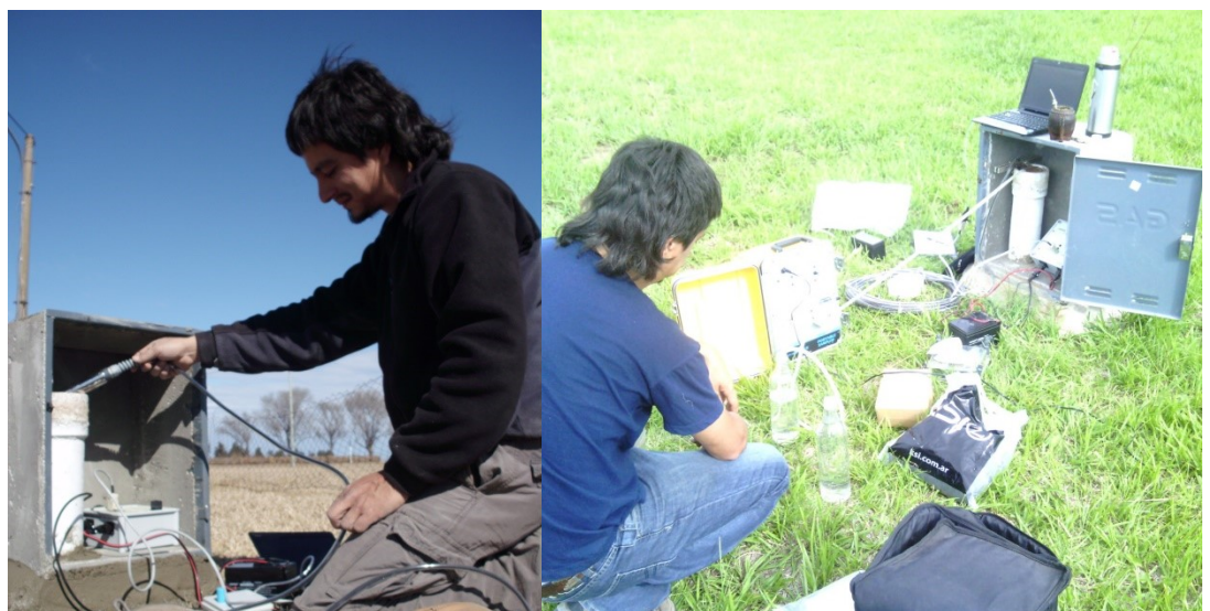
Figura 9.13 Izquierda: Construcción de casilla e Instalación de freatígrafo. Derecha: Toma de muestra con bomba peristáltica y descarga de datos con corroboración de niveles
