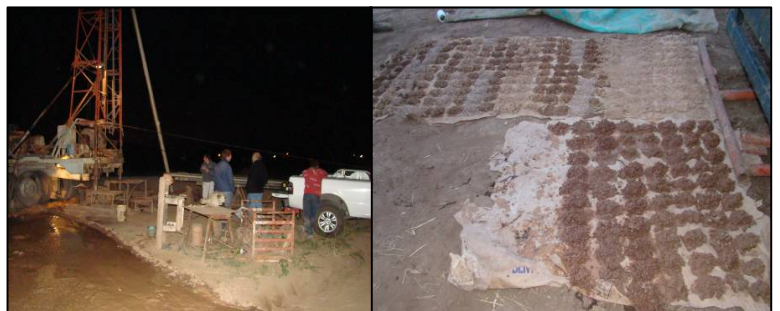
Figura 2.1, Izquierda: operación de perfilaje eléctrico en perforación utilizada para la columna "Planicie Loésica Inclinada". Derecha: Recortes de perforación tomados cada metro (300 m de profundidad). Noviembre del 2012
