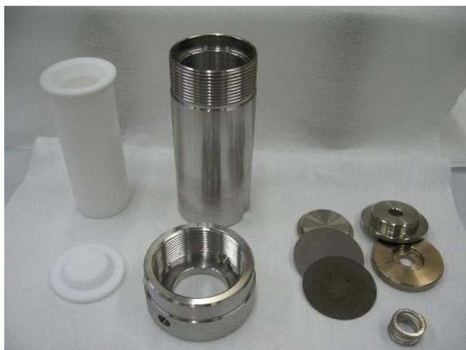
**Figura 3.3.** Autoclave Parr, modelo-4744, empleada en la síntesis de ArGO y sus derivados. De izquierda a derecha: recipiente de politetrafluoroetileno (PTFE) de 40mL, autoclave de acero inoxidable y accesorios de seguridad.
