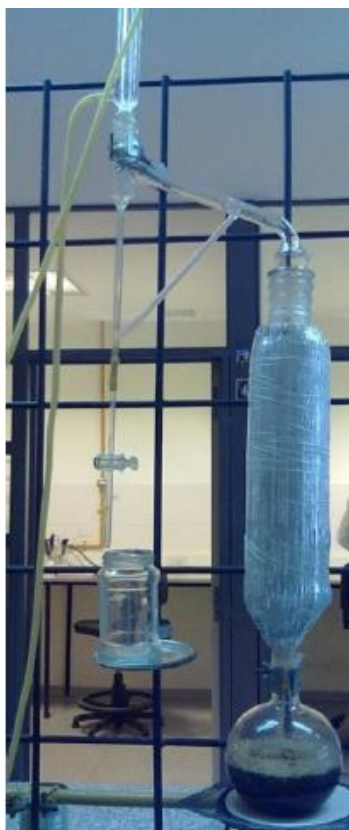
Figura 9: Equipo de hidrodestilación para la obtención de aceites esenciales
