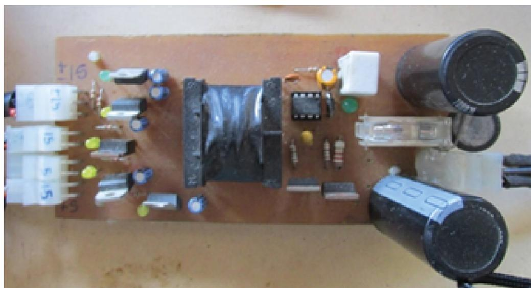
Figura A.16: Fuente de alimentación auxiliar.
