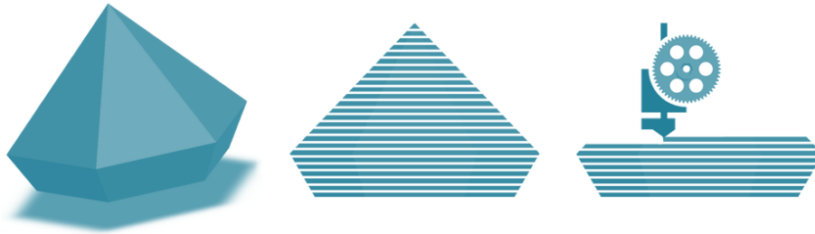
Figura 2: Proceso de impresión 3D capa sobre capa
