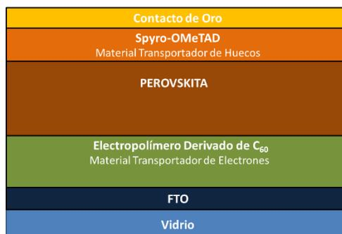
**Figura 88.** Ilustración esquemática de la arquitectura de los dispositivos bajo estudio.
