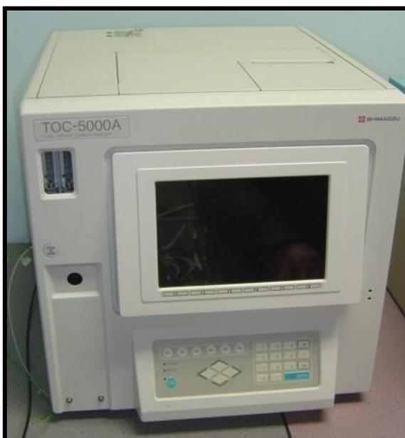
*Figura 3.4. Imagen del analizador de Carbono orgánico total Shimadzu 5000<sup>a</sup>*
