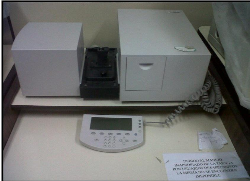
*Figura 3.1. Imagen del espectrofotómetro UV-Vis*
