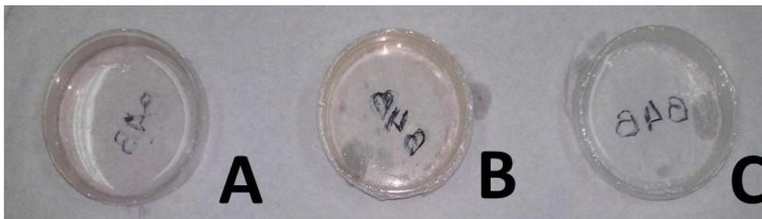
Figura 4.22. Cambios en la coloración para el proceso de foto-Fenton asistida con oxalato de [B4B]<sub>0</sub>:  $5,1 \times 10^{-5}$  M, [Fe(II)]<sub>0</sub>:  $42 \mu\text{M}$  y [H<sub>2</sub>O<sub>2</sub>]<sub>0</sub>: 5 mM, [H<sub>2</sub>C<sub>2</sub>O<sub>4</sub>]<sub>0</sub>:  $49 \mu\text{M}$ . (A). muestra de B4B t= 0 min. (B). B4B4 tras 180 min al oscuro. C. B4B tras 180 min de irradiación solar.
