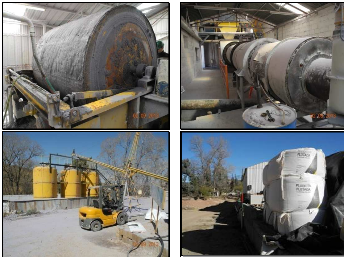
Figura 5. Proceso de secado de la Florita. A) Filtro de vacío, B) Horno de secado de la fluorita, C) Silos de almacenamiento y D) bolsones de fluorita fluotada lista para comercializar. Foto: Adolfo L. Martino.
