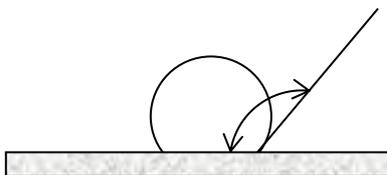
Figura IV-6. Ejemplo de membrana hidrofóbica y gota de agua.
