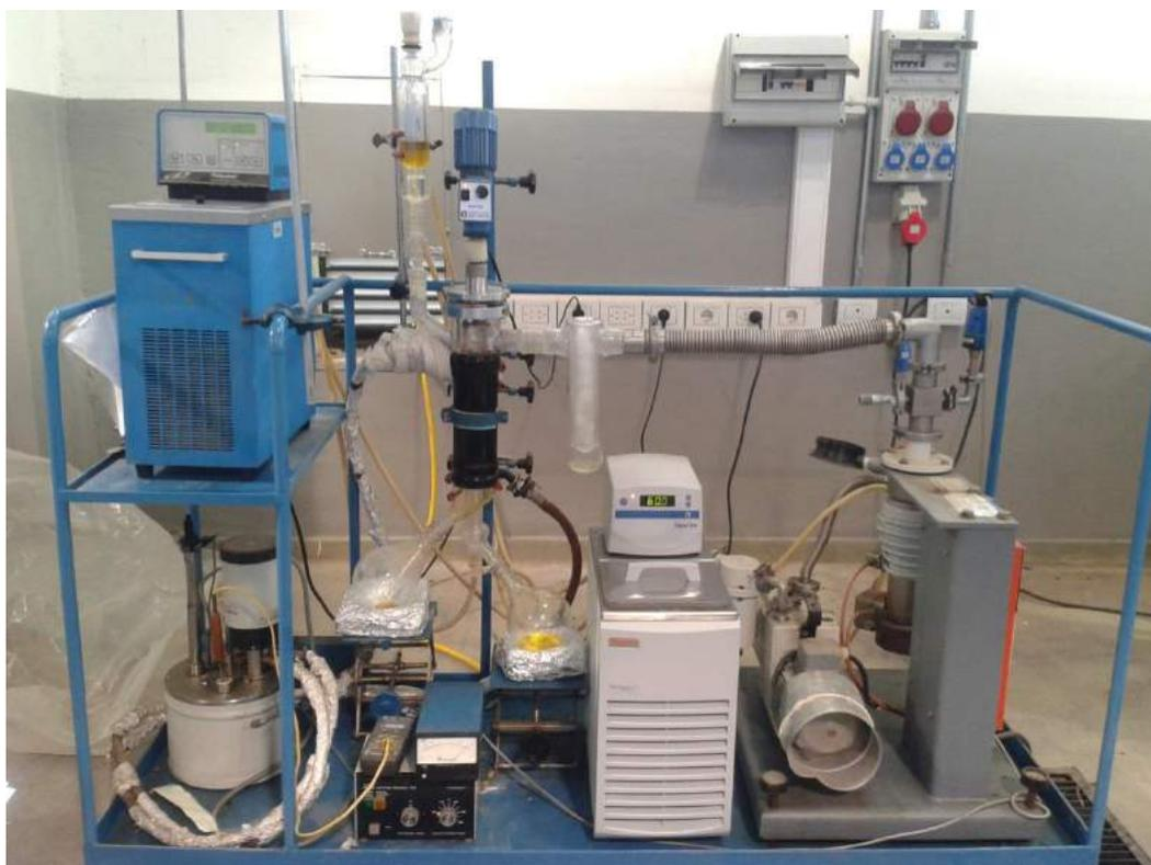
*Figura II-5. Destilador molecular KDLA con sus equipos auxiliares.*
