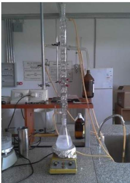
*Figura II-1. Equipo para disolución del catalizador en alcohol.*
