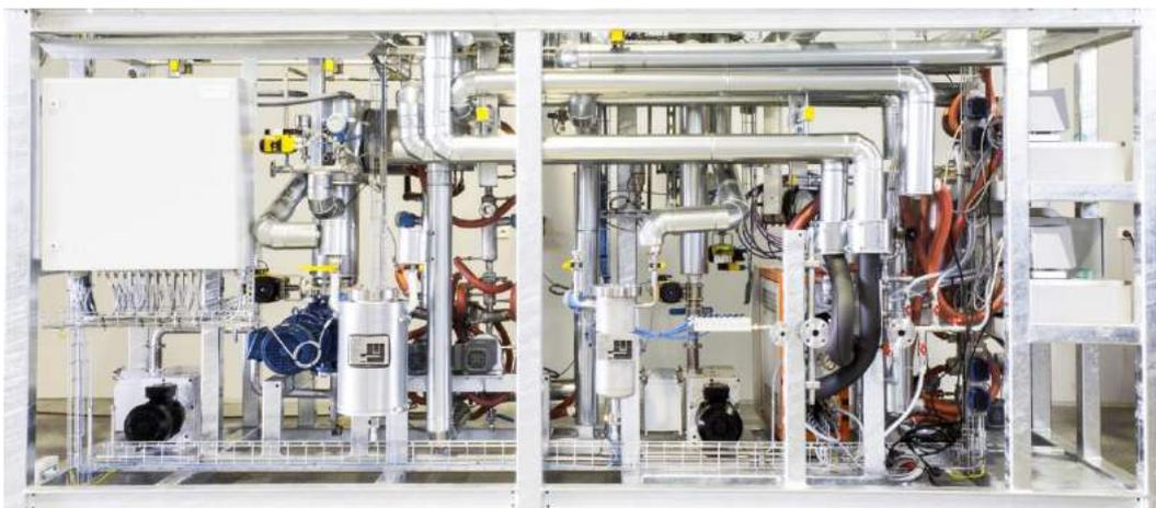
*Figura I-13. Destilador molecular escala industrial.*
