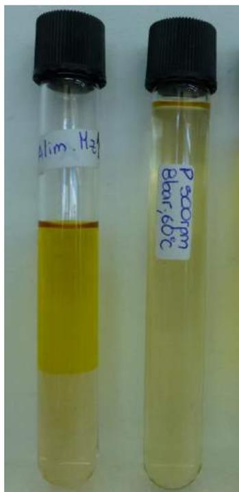
Figura IV-22. Muestras de la alimentación y el permeado a 8 bar, 60 °C.
