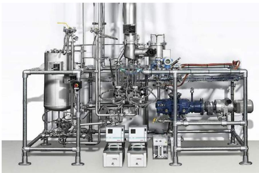
*Figura I-12. Destilador molecular escala piloto.*
