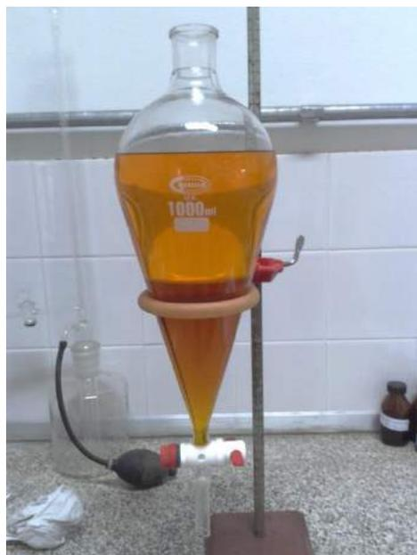
*Figura II-3. Ampolla de decantación, fracción superior: biodiesel, fracción inferior: glicerol.*
