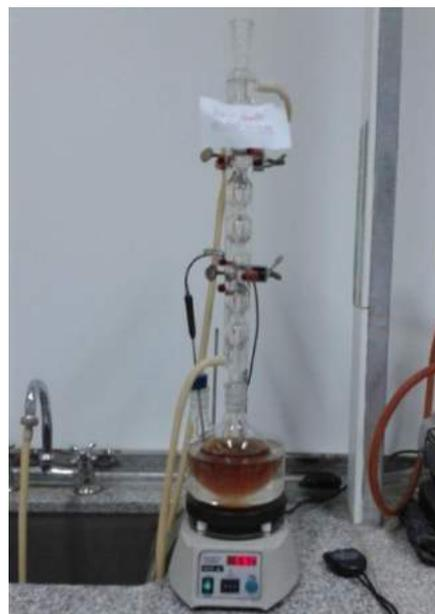
*Figura II-2. Reactor agitado de reflujo con control de temperatura.*
