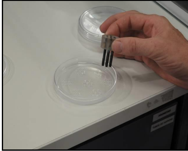
Fig 8: Agar fraccionado en placas de Petri, solidificado y perforado con un sacabocado en forma de roseta
