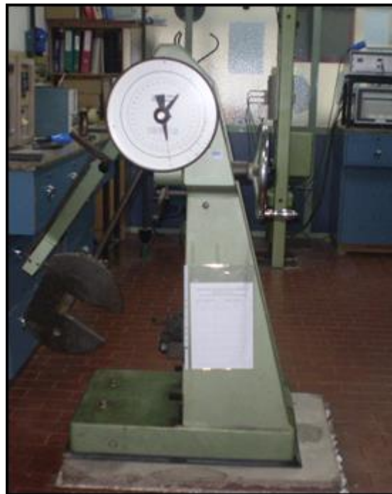
Fig. 20. Máquina de ensayo de impacto modelo: PW 30/15 K-E. Fabricante
