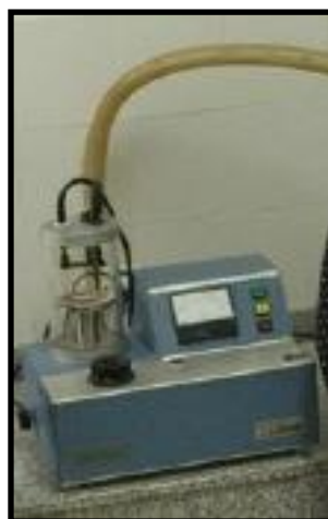
Fig. 27. Metalizadora Balzers Unión CED010.
