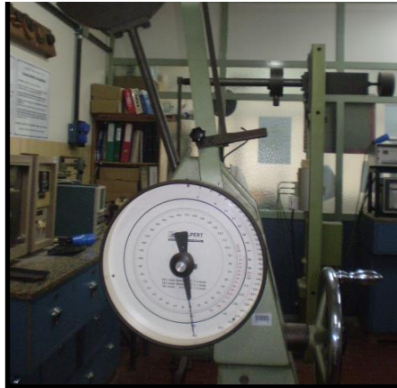
Fig. 22. Péndulo elevado hasta su posición de impacto.
