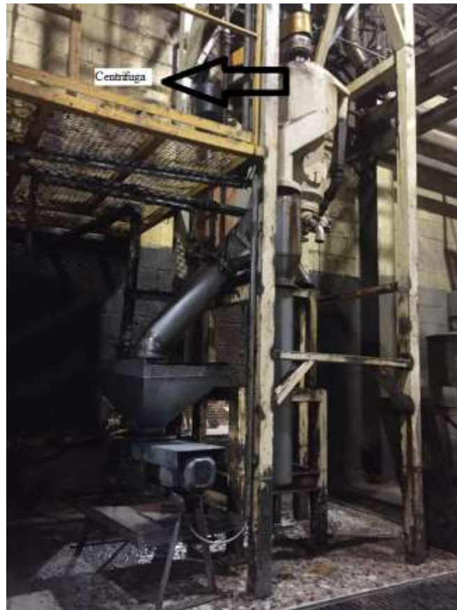
Figura AI.7: Centrífuga de aceite.
