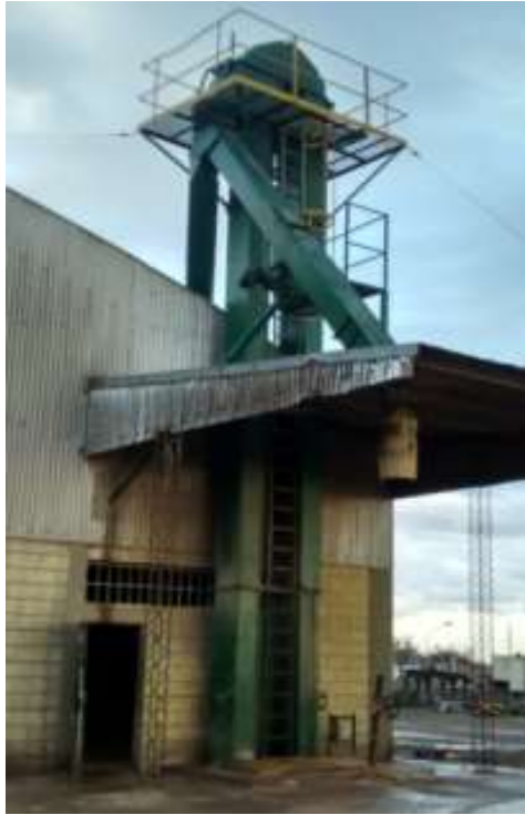
Figura AI.12: Noria de carga de expeller.
