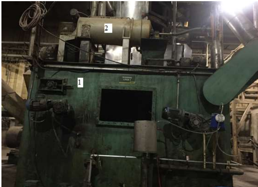
Figura AI.6: El número 1 indica al borrero de la línea 1 y el número 2 indica al decantador.
