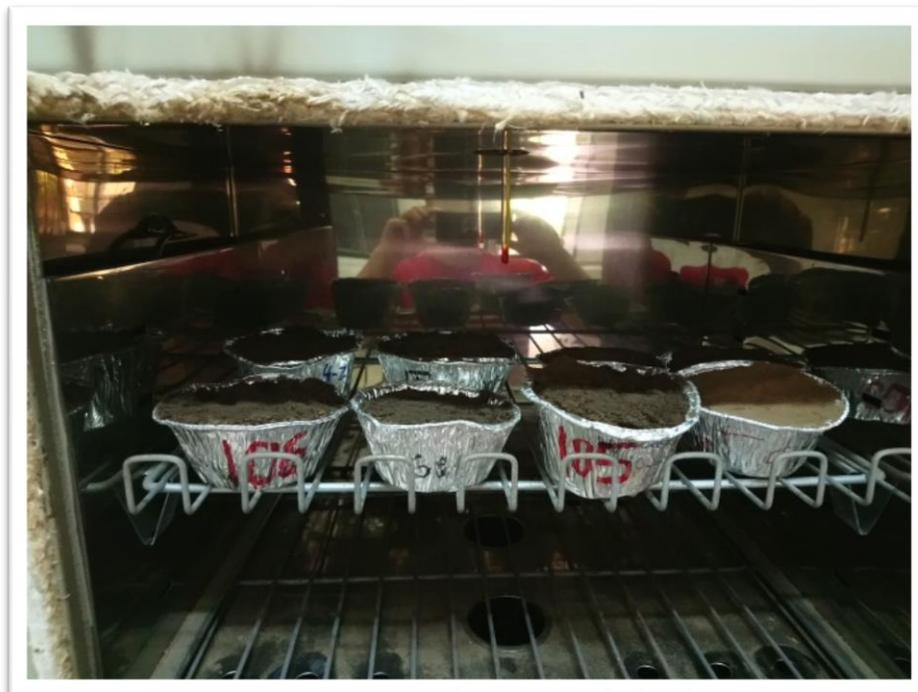
Figura 8: Muestra en la estufa de secado.
