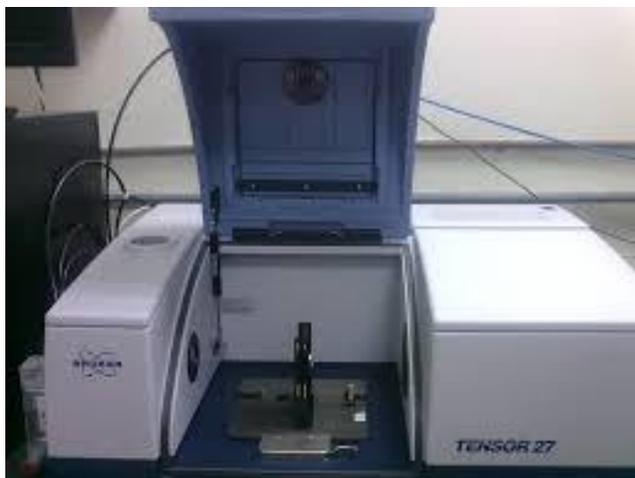
Figura III- 8: Espectrofotómetro FTIR utilizado
