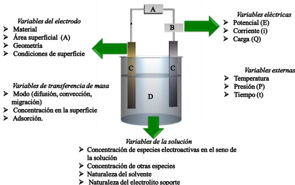
**Figura 15.** Sistema electroquímico y variables A) fuente de Potencial; B) microamperímetro; C) electrodos; D) solución electrolítica.
