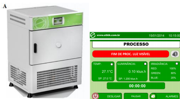
Esquema A 1. Sistema de irradiación: cámara de irradiación (A), sistema de control de parámetros (B) .
