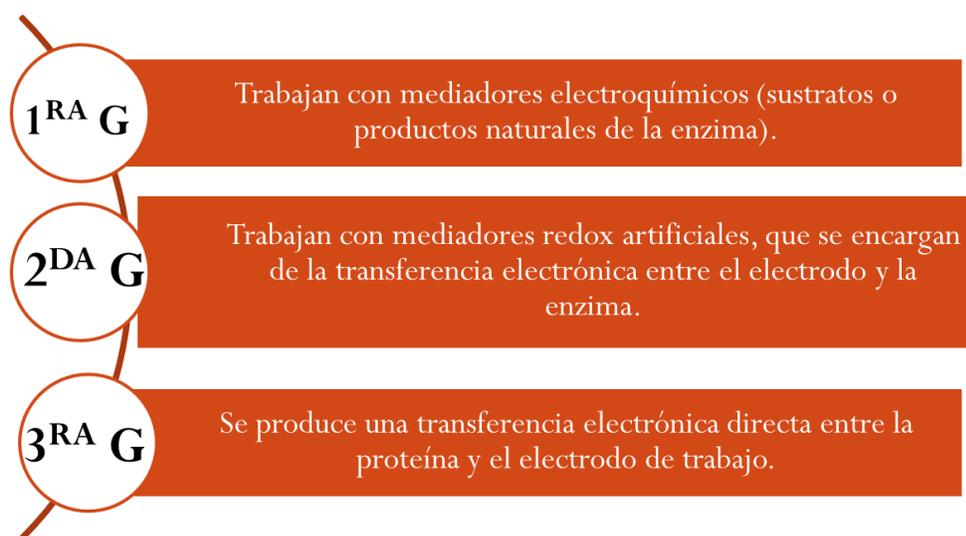
**Figura 2.18.** Esquema que describe las características de los biosensores de primera generación ( $1^{RA} G$ ), de segunda generación ( $2^{DA} G$ ) y de tercera generación ( $3^{RA} G$ ),
