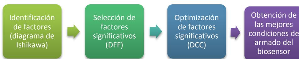
**Figura 3.3.** Esquema de los pasos seguidos para encontrar las mejores condiciones de armado de los biosensores enzimáticos amperométricos para la determinación  $H_2O_2$  y de EUG.
