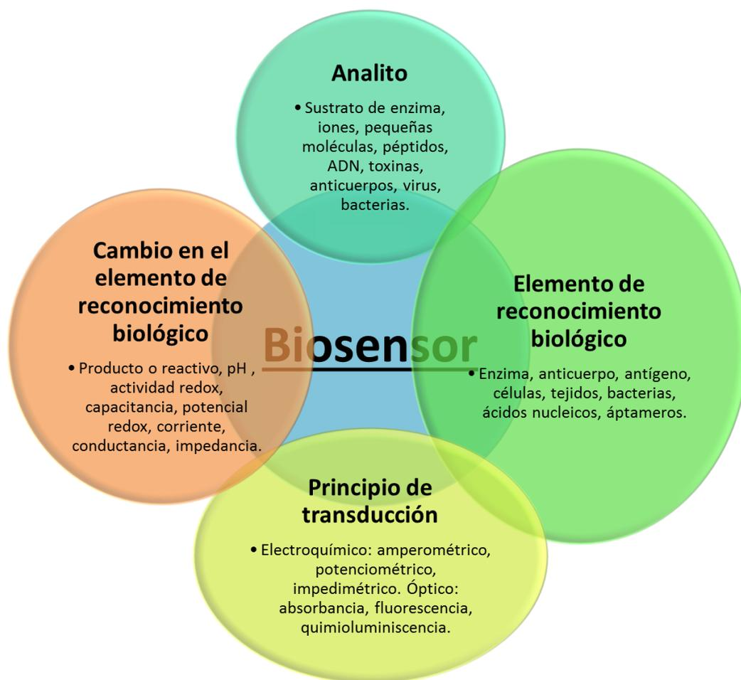
**Figura 2.17.** Componentes de un biosensor. Esquema adaptado de Borgmann y col. (2010).
