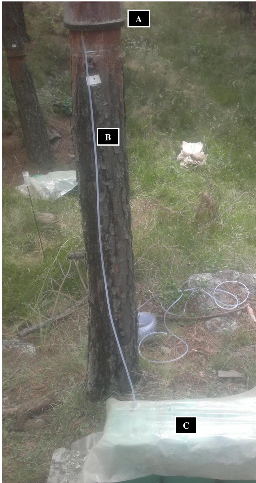
Figura 2.1: Dispositivos montados para la medición del escurrimiento fustal. A: colector de goma y acetato; B: manguera de conducción; C: tanques de almacenamiento calibrados.
