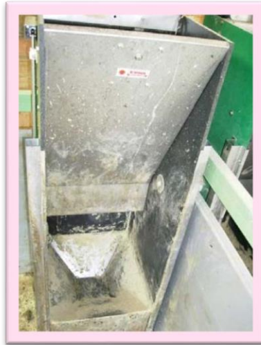
Figura 34: Sistema de tolva manual
