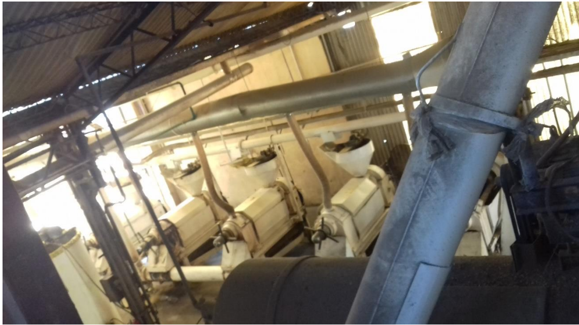
Figura AVI-8: Elaboración de Expeller&Aceite de Soja(Prensas)
