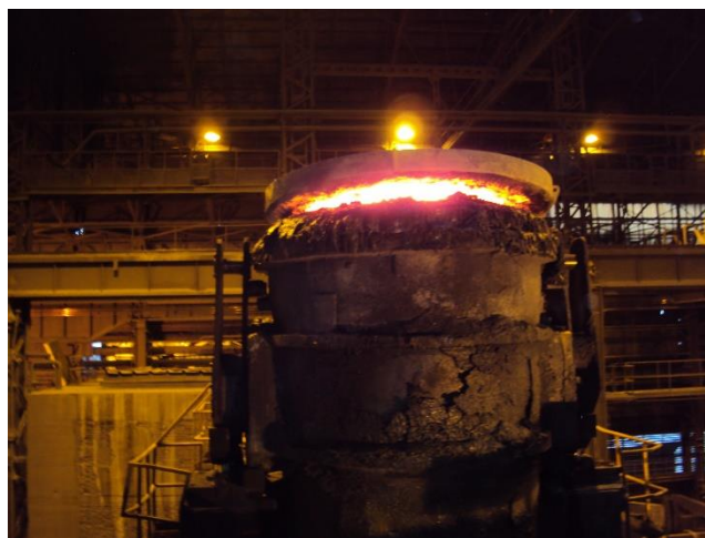
Ilustración 2: Cuchara con acero líquido
