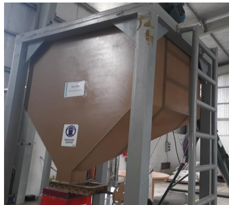
ILUSTRACIÓN A1.5 TOLVA DE ALMACENAMIENTO (TA1701)
