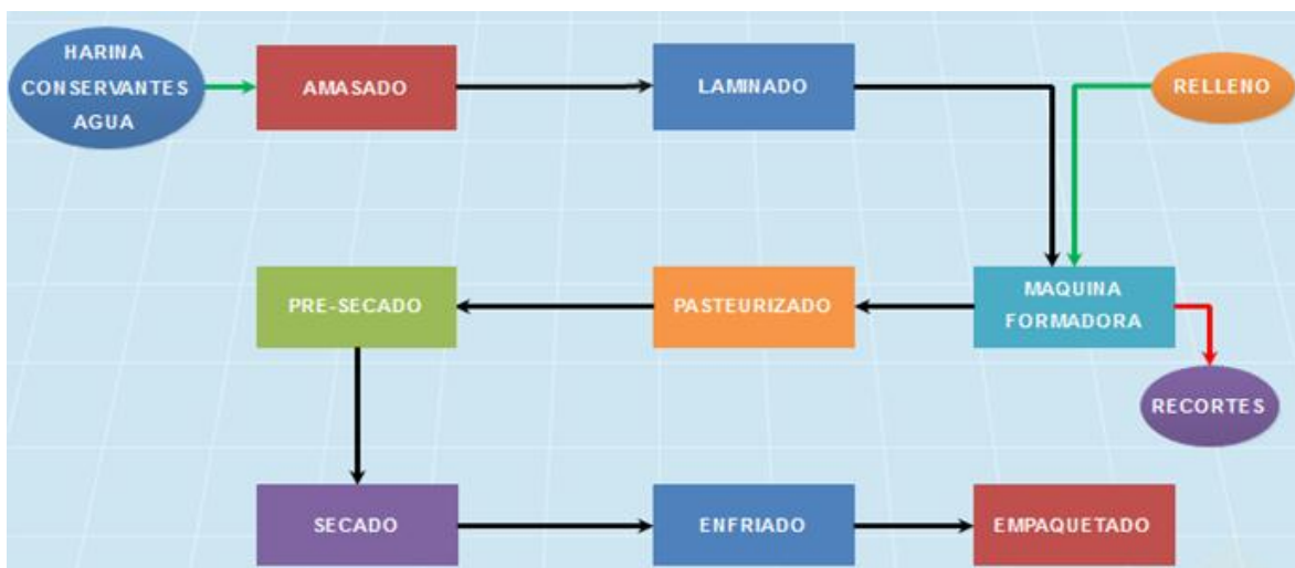
Figura N° 2: Diagrama de bloque de la línea de pasta fresca pasteurizada.
