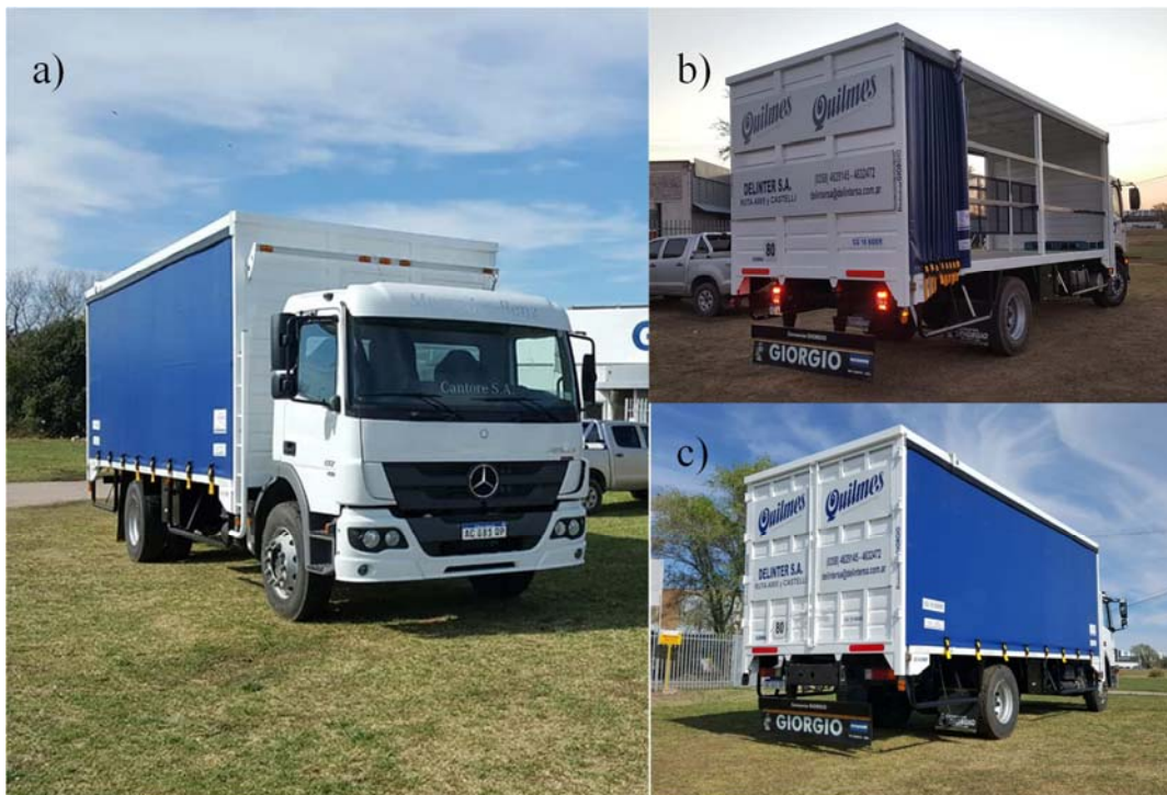
Fig. 4: Carrocería Sider; a) vista frontal; b) carrocería sin puertas traseras; c) carrocería con puertas traseras.
