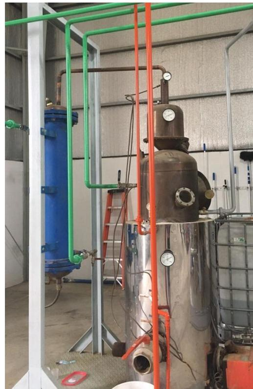
*Figura AI. 7 Destilador y condensador*
