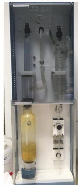
Figura AIV. 14 Destilador automático
