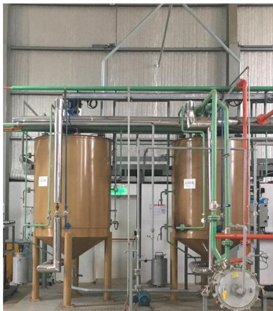
*Figura AI. 6 Tanques de fermentación*
