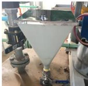
Figura 1 Tolva dosificadora de Alfa-amilasa e hidróxido de sodio.
