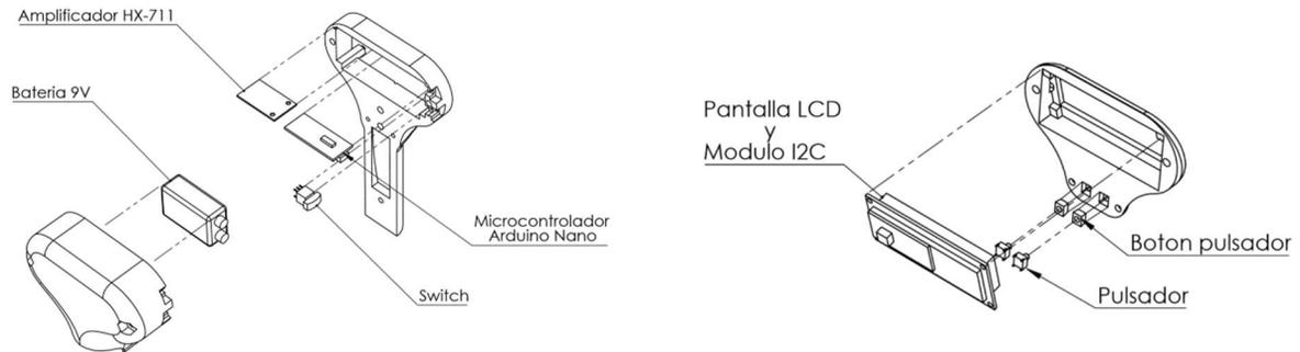
**Figura 13: Vista en explosión de los componentes electrónicos.**
