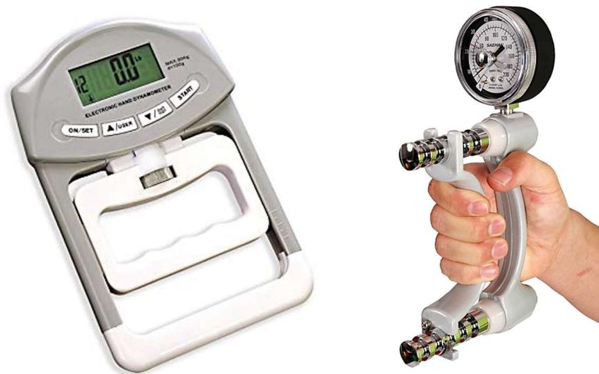
**Figura 2: Modelos de dinamómetros de mano.**
