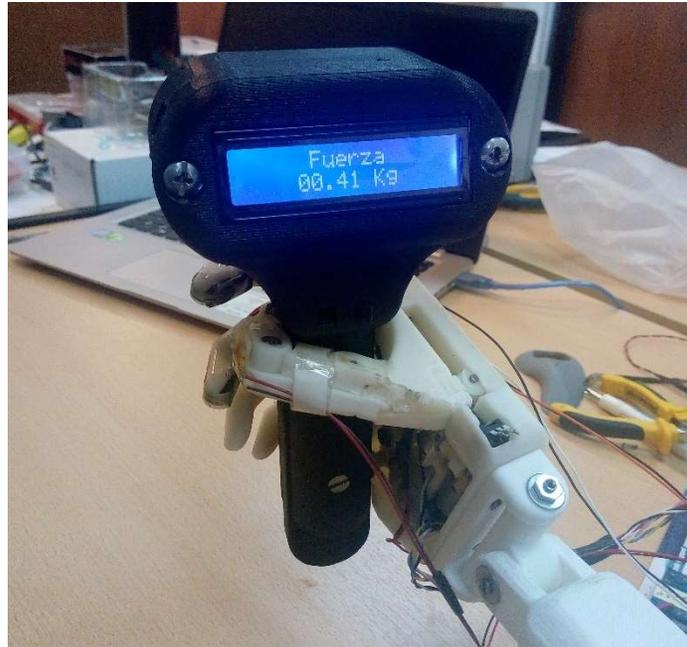
**Figura 17: Dinamómetro finalizado y realizando una medición.**
