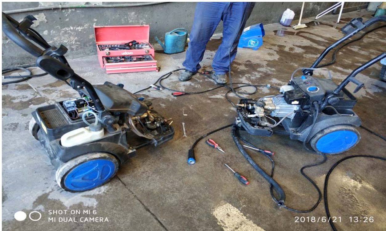
f- Diagnóstico de falla en hidrolavadora Industrial
