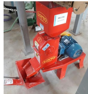
Figura A1.2 Molino de martillo Royto MG 1701
