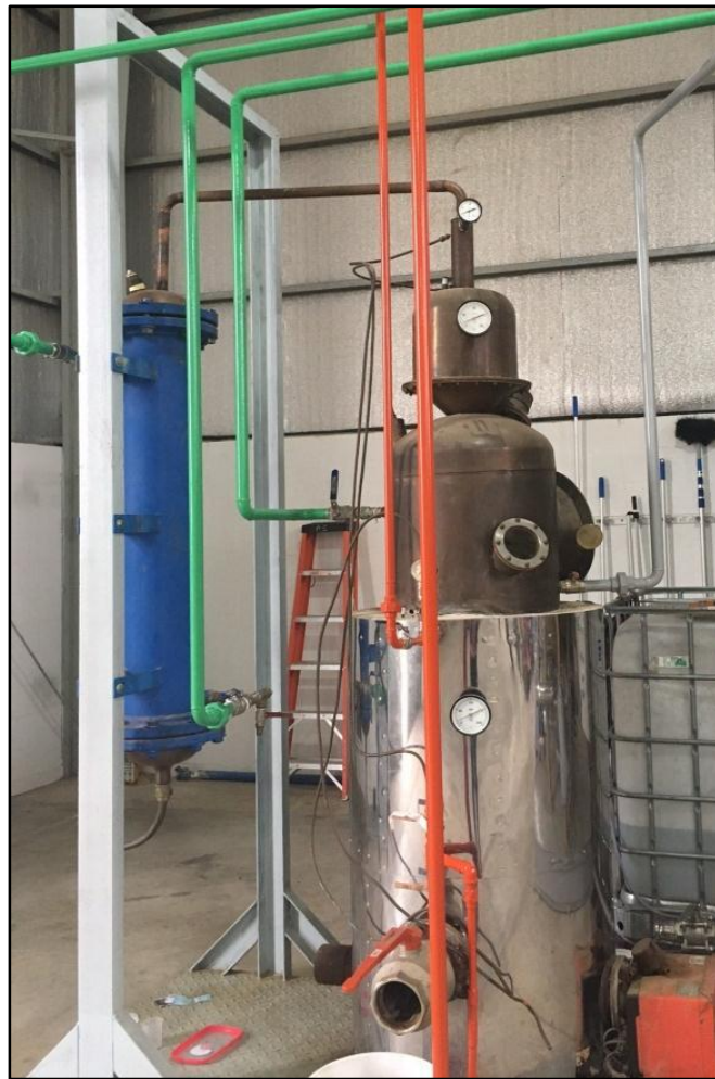
Figura A3.8: Destilador y condensador
