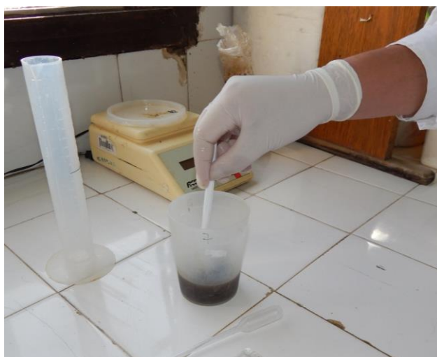
Figura 12. Homogeneizar bien la mezcla previo a la carga de la cámara es un paso clave para la confiabilidad de los resultados.
