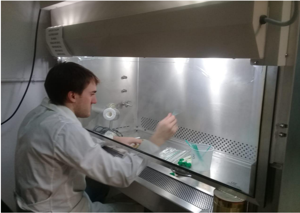
Imagen N°12. Siembra de las muestras de leche en placas con agar micoplasmas .
