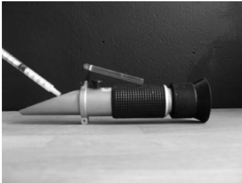
FIGURA 8. El refractómetro Brix se puede utilizar para estimar indirectamente IgG calostrual. McKinnon et al. ,
