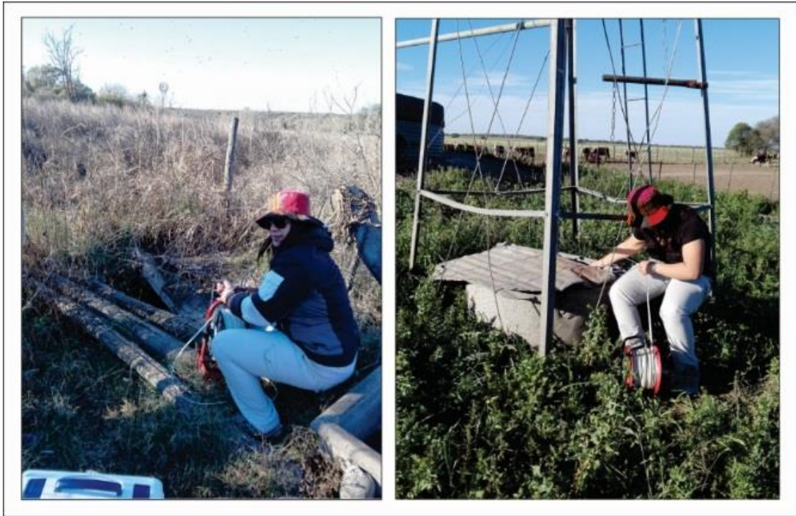
Figura N° 2.1: Medición de nivel freático sonda piezométrica de señal lumínica y sonora.
