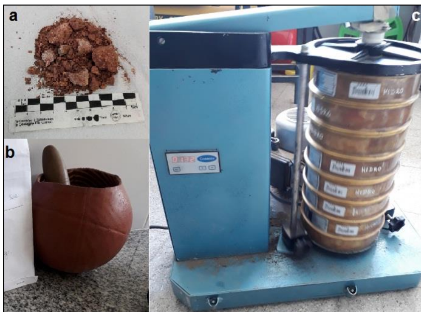
Figura N° 2.3: a- muestra a tamizar; b- mortero de goma; c- tamices colocado en agitador.
