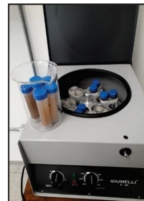
Figura N° 2.6: Tubos colocados en centrífuga.
