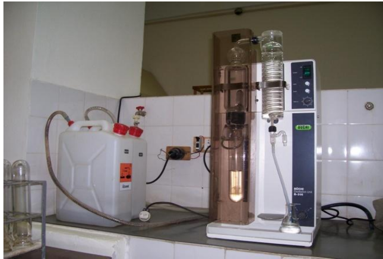
FIGURA 7. Neutralizador y Destilador semiautomático de Kjeldahl para análisis de proteína bruta.
