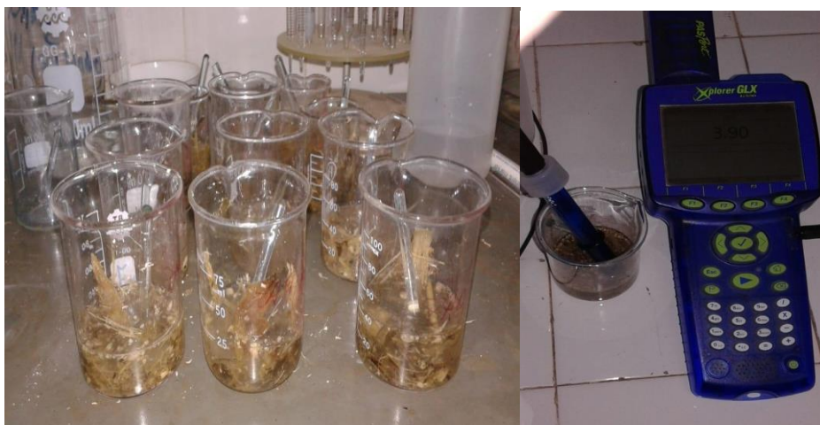
FIGURA 9. Preparación de silaje de maíz en solución acuosa (izquierda), medición de pH (derecha).
