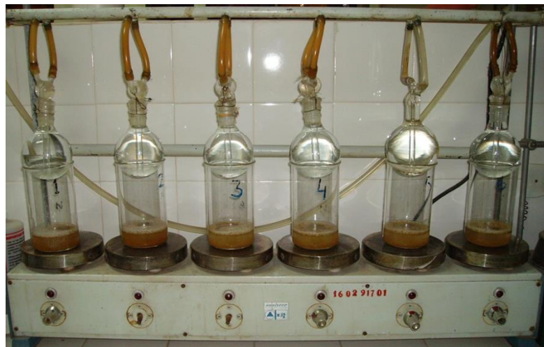
FIGURA 8. Digestor de fibra en el Laboratorio de Nutrición Animal de la FAV de la UNRC.
