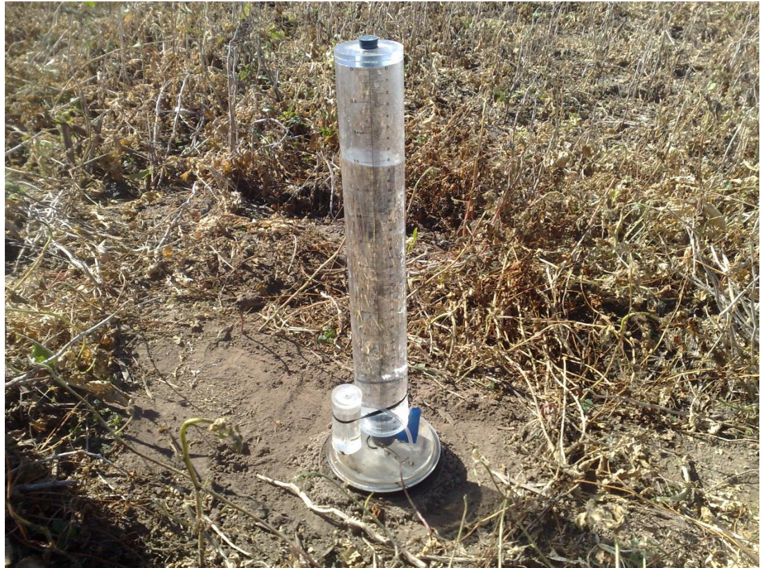
Anexo 6.4 Foto N°1: Permeámetro a disco utilizado en este trabajo
