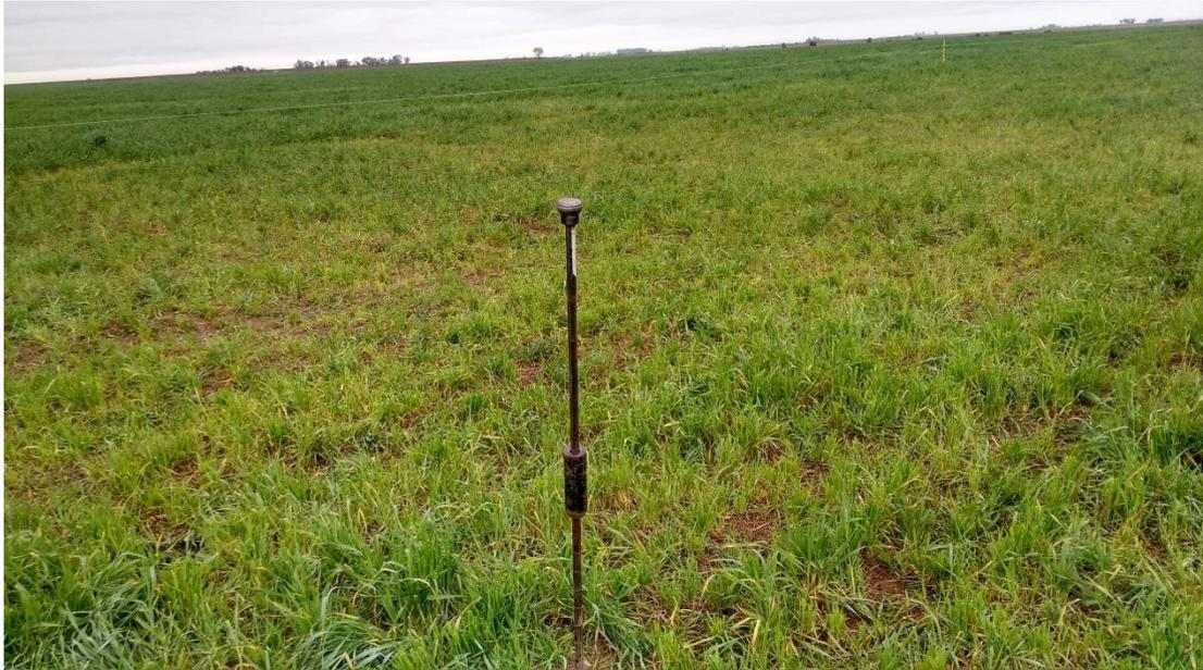
Figura N° 12: Medición de resistencia mecánica con penetrómetro luego del pastoreo.
