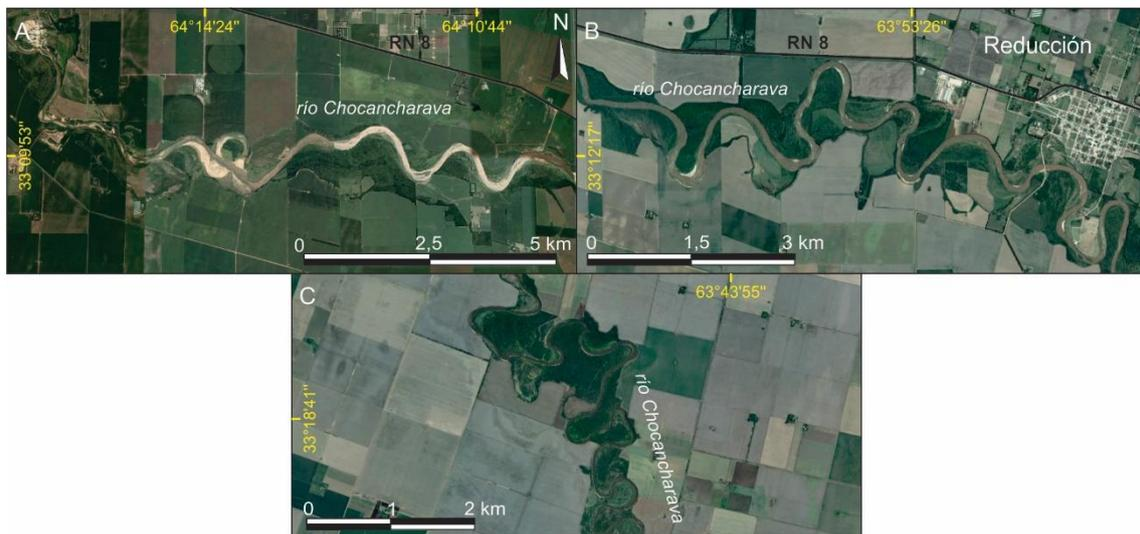
Figura VI.8: Variación de sinuosidad y geometría de meandros dentro del tramo medio del río Chocancharava. A) segmento representativo de S1; canal de baja sinuosidad, regular. B) segmento representativo de S2; canal de alta sinuosidad, irregular. C) segmento S3; canal de alta sinuosidad, muy irregular.
