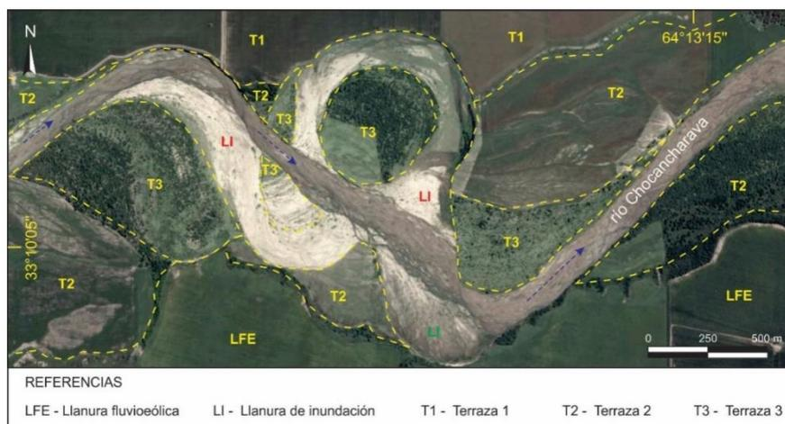
Figura VI.14: Imagen mostrando los 3 niveles de terrazas en un tramo meandriforme de alta sinuosidad rectificado naturalmente en 2015, correspondiente al segmento 1.
