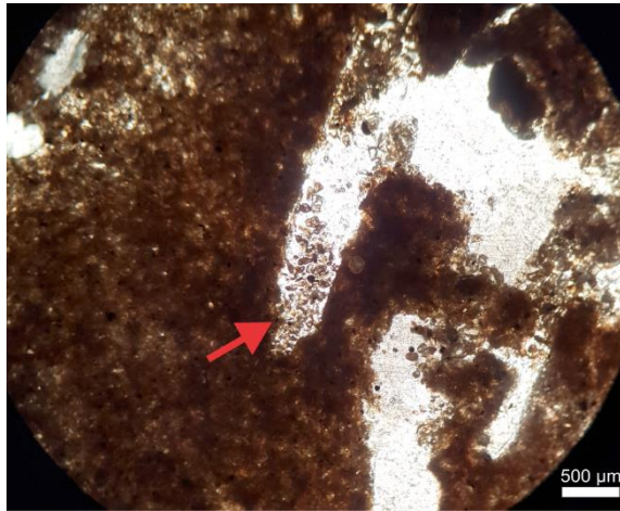
Figura 60. Relleno suelto discontinuo (nicoles paralelos).
