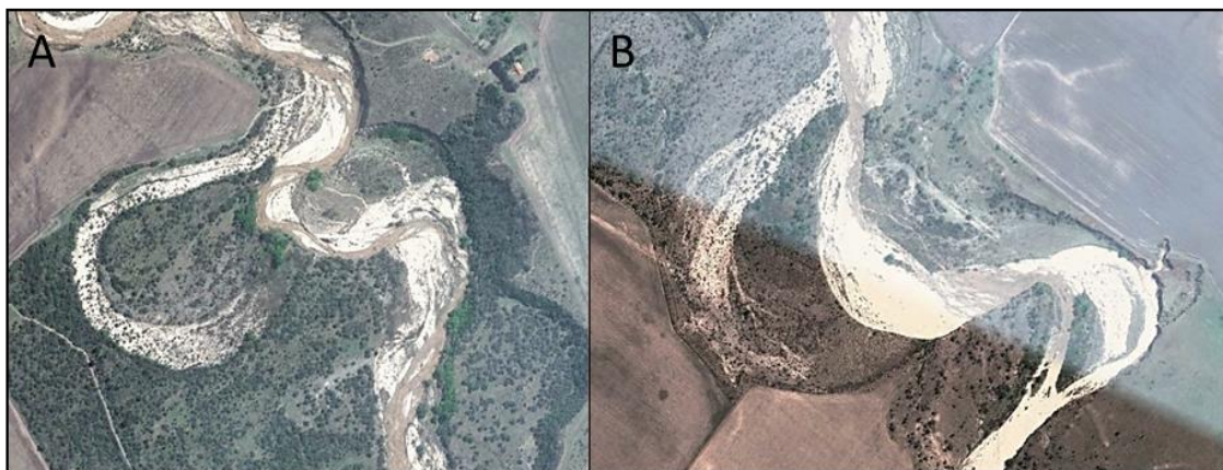
Figura III.42: Meandros abandonados por: A) proceso de estrangulamiento y B) acortamiento entre espiras, reconocidos en la faja fluvial del río San Bartolomé.
