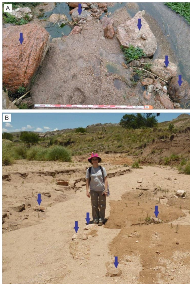
Figura VII.10. Clastos utilizados para el cálculo del caudal de crecida por el método Paleohidráulico (A) en la estación de aforo H y (B) en la estación G.
