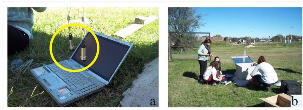
Figura VIII.18.a y b. Instalación del “diver” para monitoreo diario del Nivel Freático.
