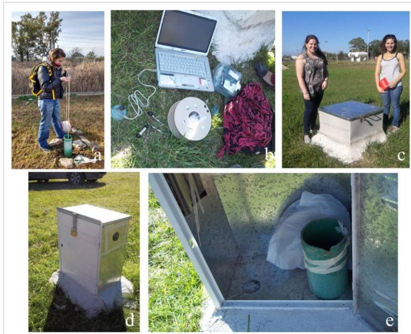
Figura 1.4: a. Monitoreo del Nivel Freático con sonda piezométrica en *Pf*. b. Preparación del equipo para instalar el data logger. c. Perforación profunda *Ps1* con el equipo instalado. d y e. Perforación *Pf* bajo estudio en la que se instaló el data logger.
