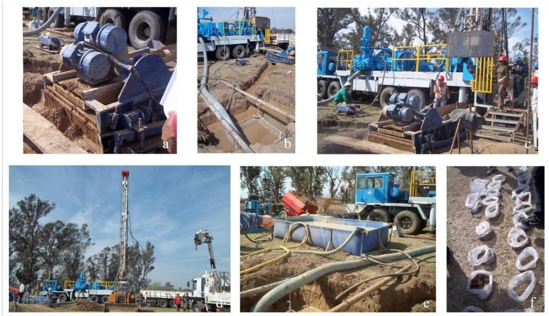
Figura I.3. a: Salida de los sedimentos de la perforación. b: Circuito del lodo. c: Equipo de perforación. d: Equipo de perforación con torre para ubicar las barras de perforación. e: Pileta de lodos. f: Muestras procedentes de la perforación.
