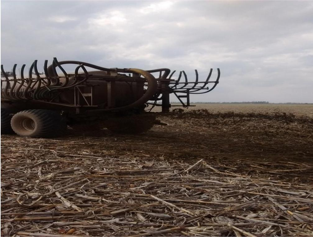
**Figura 7: Estercolera aplicando el digestato con tubo de descarga libre tipo cola de novia**
