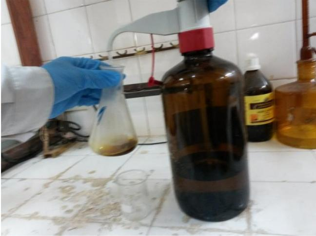
Figura 14: Parte del método para determinar contenido de materia orgánica.
