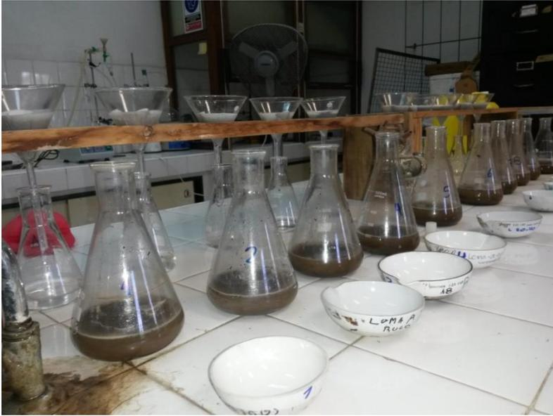
**Figura 15: Distintas muestras de suelo pertenecientes a las distintas parcelas del ensayo usadas para la determinación de nitratos.**
