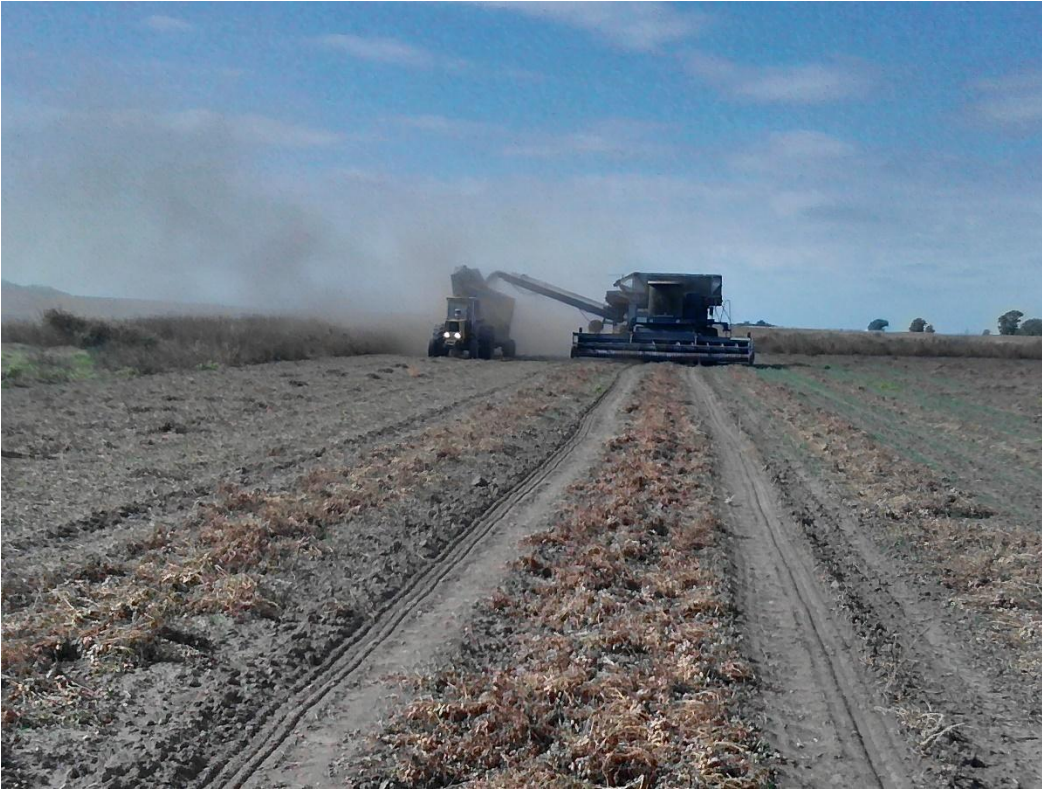
Imagen 15: Máquina cosechadora, de triple andana, trabajando en un maní bien oreado con 11% de humedad. Campo Garcia, (Las Vertientes)
