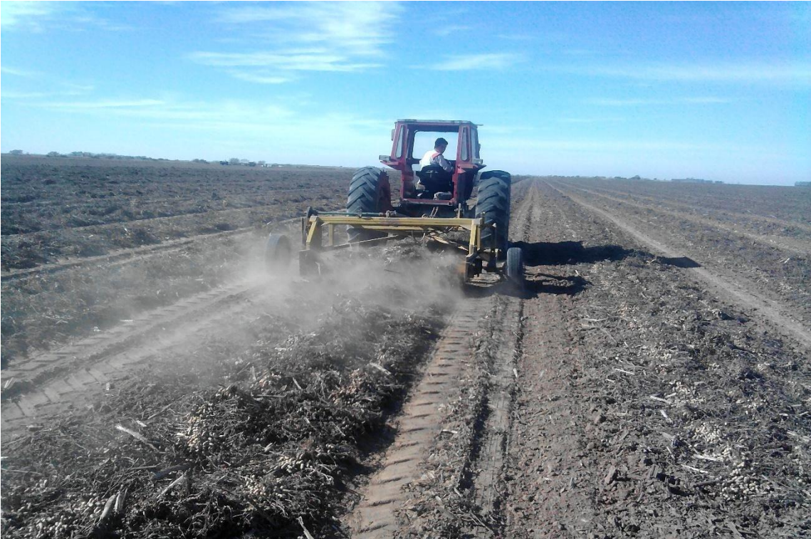
Imagen 17: reduciendo la tierra del maní con el removedor. Campo San Lorenzo (Santa Flora)
