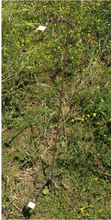
Foto N° 2: Soporte porta tarjeta y tarjeta hidrosensible.
