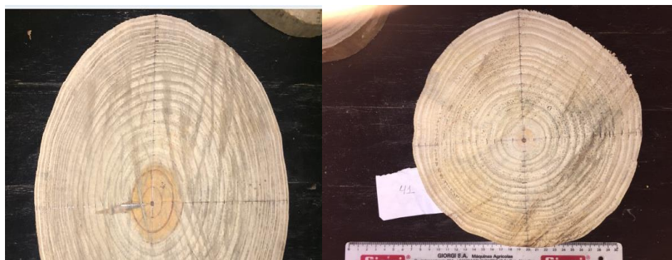
Fig. 5- Imagen donde se aprecian los anillos de crecimiento de las rodelas medidas.
