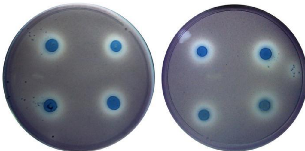
Fig. 3. Imagen representativa que muestra la formación de un halo transparente de solubilización de fosfato alrededor de las colonias bacterianas.
