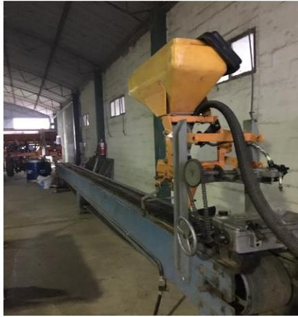
**Figura N°3.** Banco de ensayo estático con sist. de transmisión flexible.
