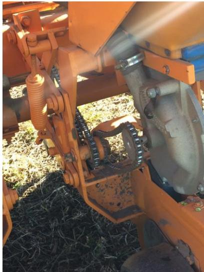
**Figura N°1.** Tren de siembra con sist. de transmisión tradicional.
