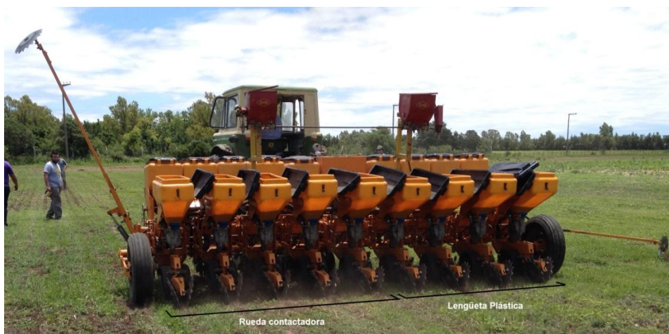
Figura 2. Disposición de los órganos contactadores de semilla en la sembradora.
